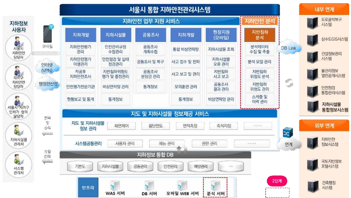
[그림] 통합 지하안전관리시스템의 구성도
