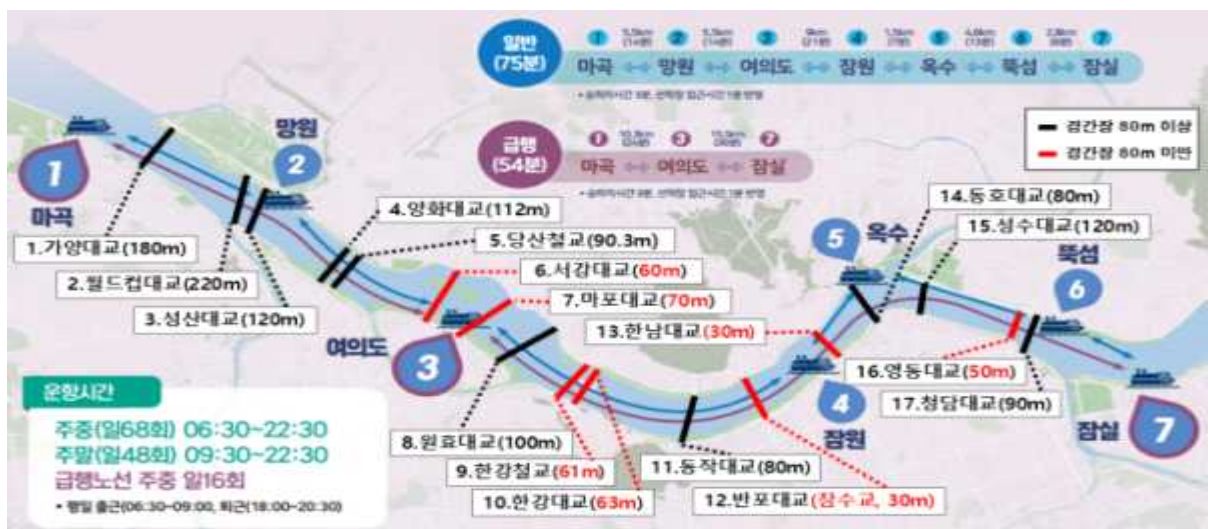
[그림 8] 한강버스 운항 구간 내 교량 및 교량별 경간장 현황
