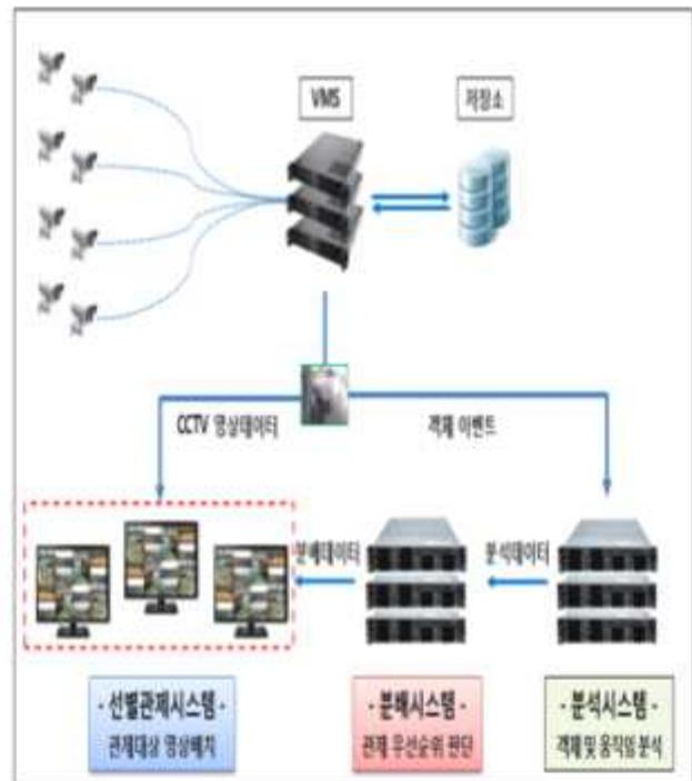
○ ‘지능형 선별 관제시스템’은 지능형 CCTV 기술을 이용하여 사람, 차량 등 관제대상 객체의 움직임이 있는 CCTV 영상만을 선별하여 관제화면에 표출하는 시스템으로 범죄예방, 재난방지 등 안전을 이유로 CCTV가 지속적으로 증가함에 따라 기존 관제 인력만으로는 효율적인 관제가 현실적으로 어려워짐에 따라 관제요원의 업무 부담을 줄이고, 관제 시각 지대 해소 등을 위한 것으로 보임.
