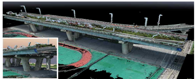
〈드론을 이용한 기존 구조물 3D 모델링(광진교)〉
