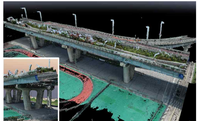
〈드론을 이용한 기존 구조물 3D 모델링(광진교)〉
