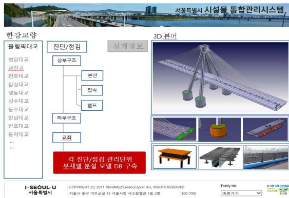
〈BIM 적용 통합 유지관리 시스템 플랫폼 예시〉
