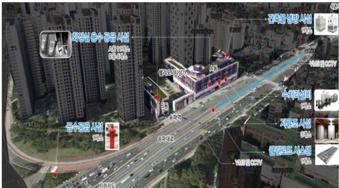
[그림] 송파대로 클린로드 물순환시스템 구축 계획도
