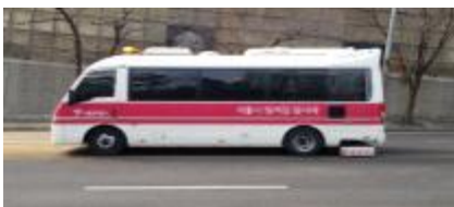
차량형 GPR(시도, 간선도로)
